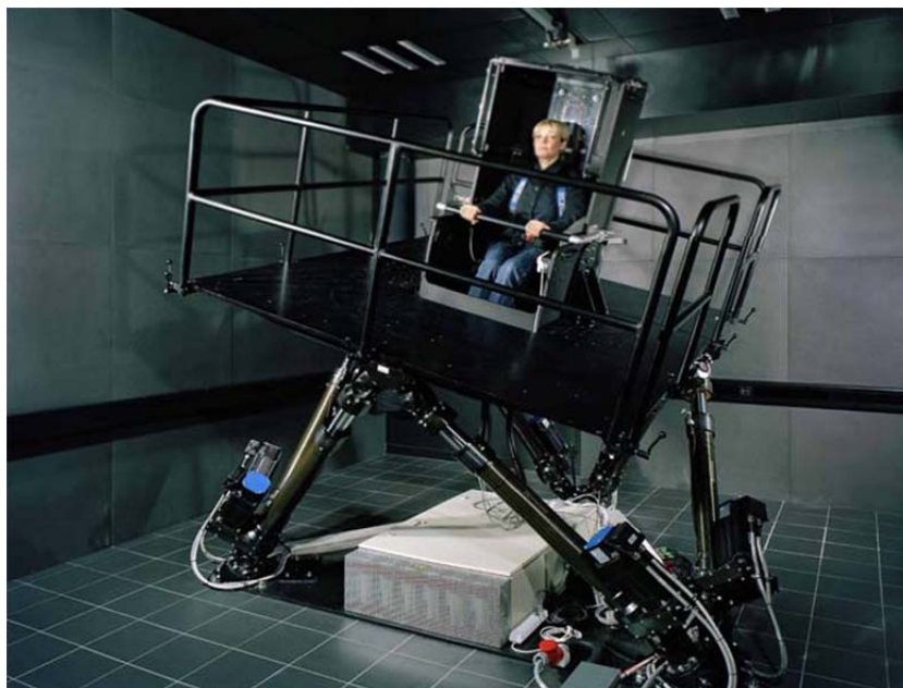
Abbildung 5. Bewegungssimulator (Hexapod), der es erlaubt, kinematisch und dynamisch exakt definierte Beschleunigungsreize mit 6 Freiheitsgraden (3 lineare und 3 rotatorische) zu applizieren.
