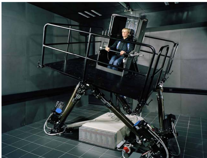
Abbildung 8. Bewegungssimulator (Hexapod), der es erlaubt, kinematisch und dynamisch exakt definierte Beschleunigungsreize mit 6 Freiheitsgraden (3 lineare und 3 rotatorische) zu applizieren.
