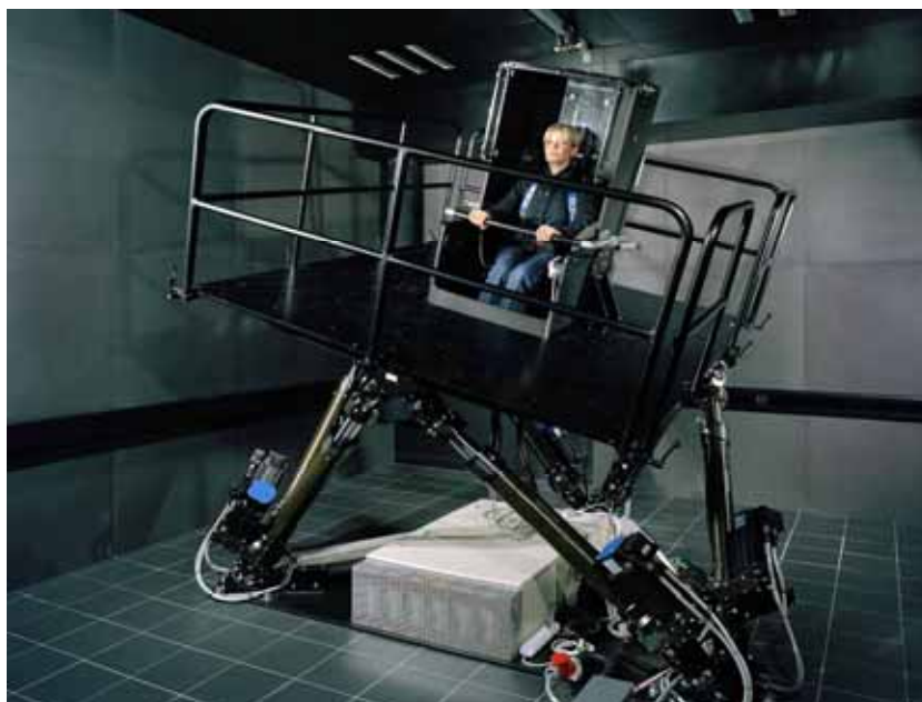
Abbildung 7. Bewegungssimulator (Hexapod), der es erlaubt, kinematisch und dynamisch exakt definierte Beschleunigungsreize mit 6 Freiheitsgraden (3 lineare und 3 rotatorische) zu applizieren.
